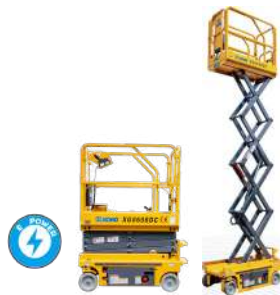
XG0608DC Arbeitshöhe: 6,30m Hubkapazität: 240kg Batterie: 24V/80Ah
