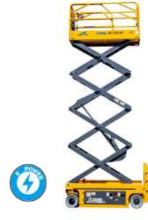
XG1012AC Arbeitshöhe: 10,0m Hubkapazität: 450kg Batterie: 24V/200Ah Bleibatterie 25,76V/202Ah Lithium (optional)
